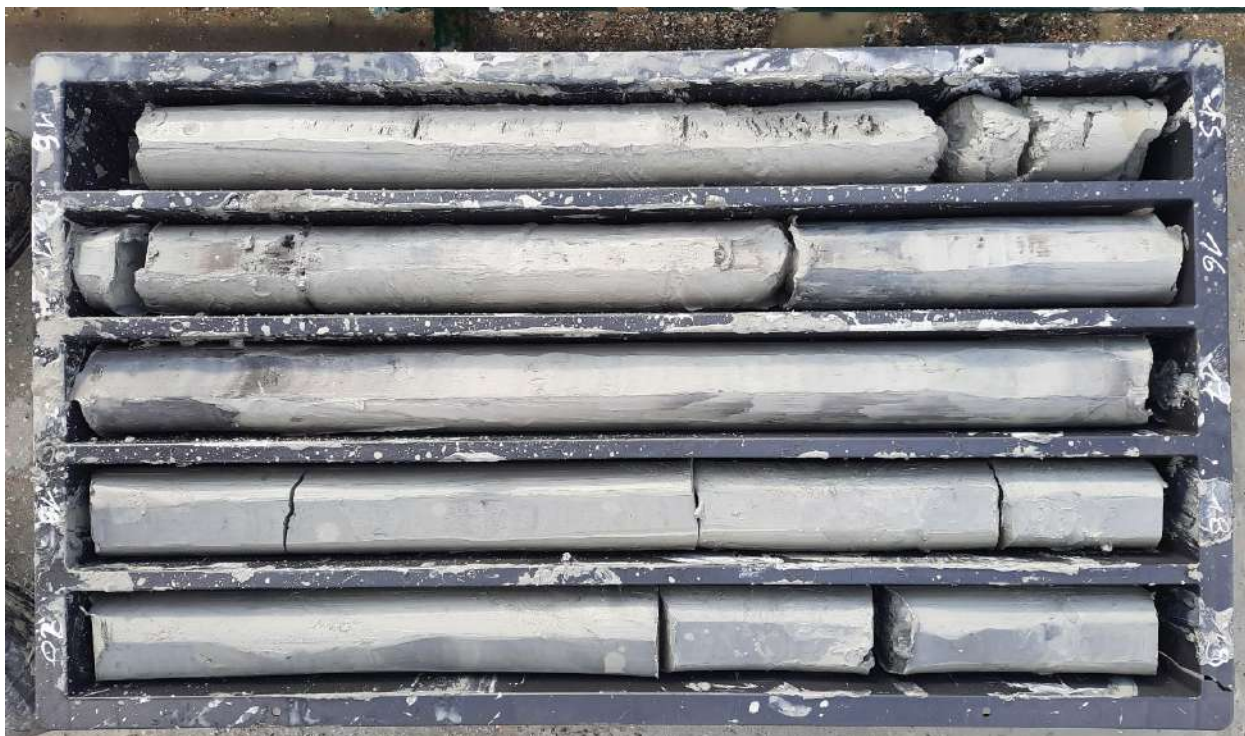
Cassetta carote n°4 (profondità da -15.0 a -20.0 m)
