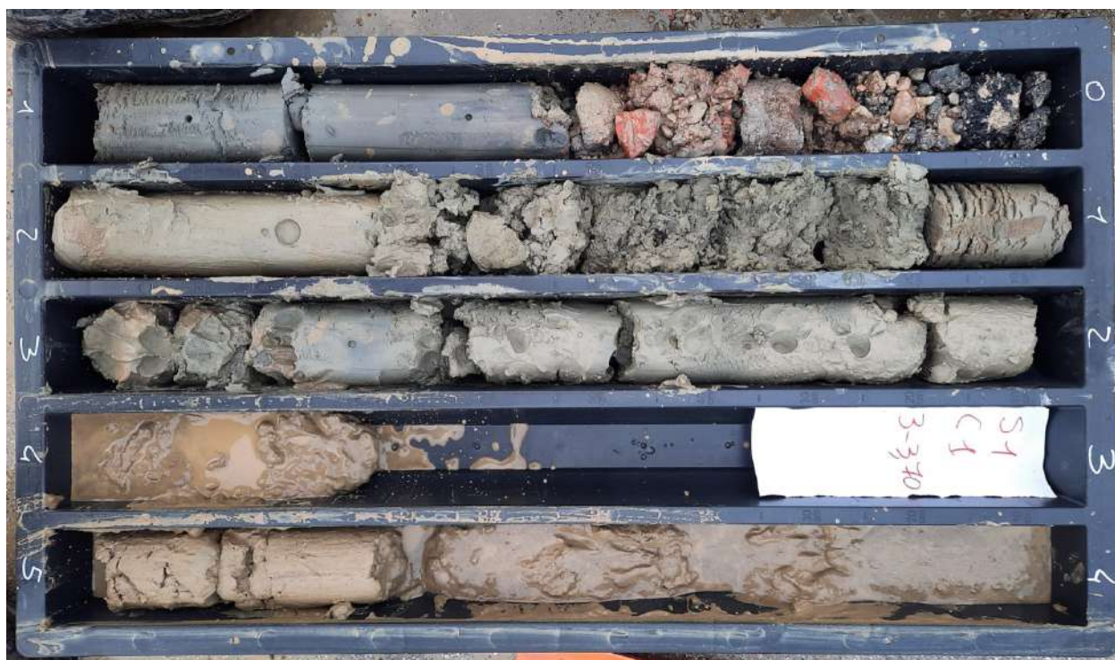
Cassetta carote n°1 (profondità da 0.0 a -5.0 m)
