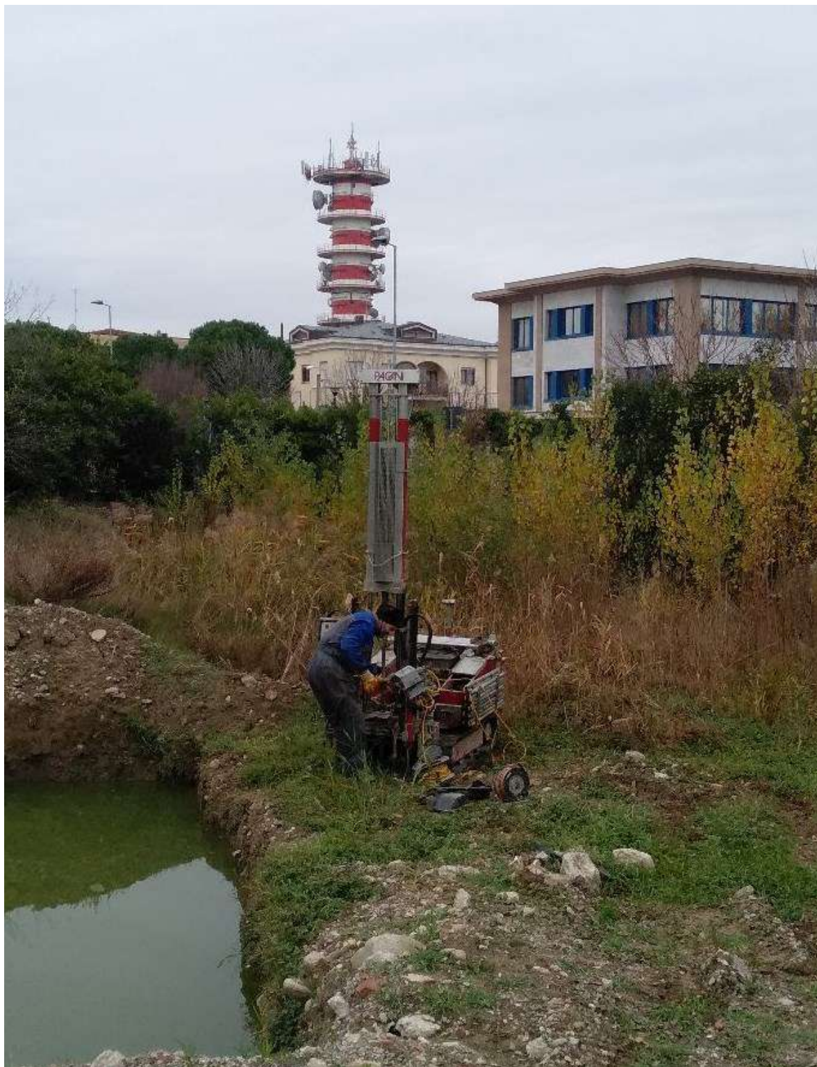
Fig. 17b Penetrometro “PAGANI” dotato di piezocono sul punto di prova CPTU2 (la quota d’inizio di questa prova è ribassata di circa 2 m rispetto la quota d’inizio della CPTU1)
