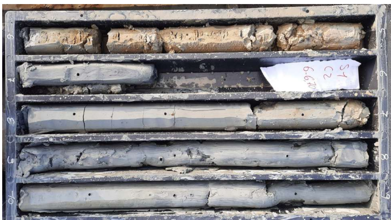
Cassetta carote n°2 (profondità da -5.0 a -10.0 m)
