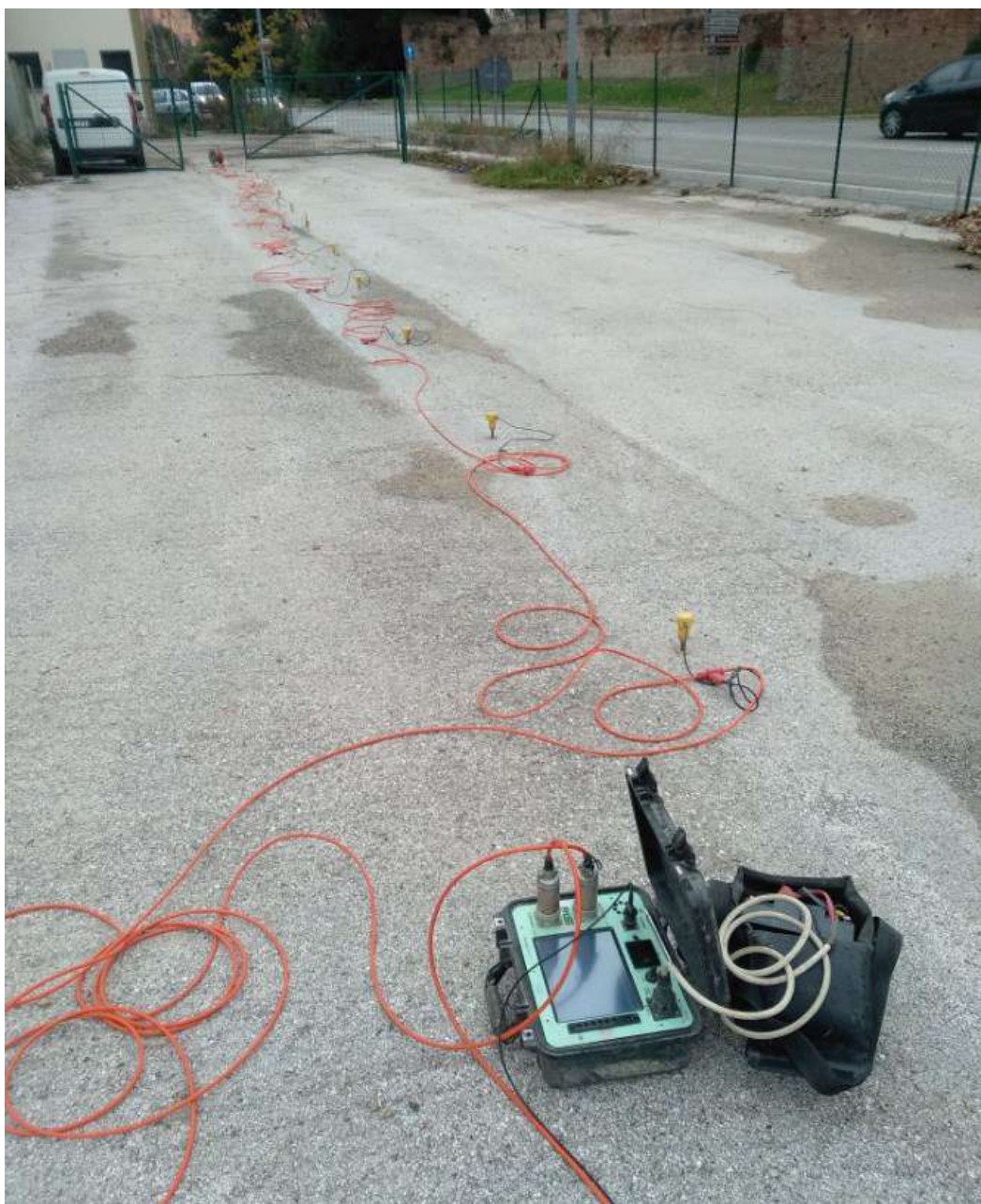
Fig. 27 Stendimento geofoni sul piazzale dell'area Ex Fox e centralina di acquisizione
