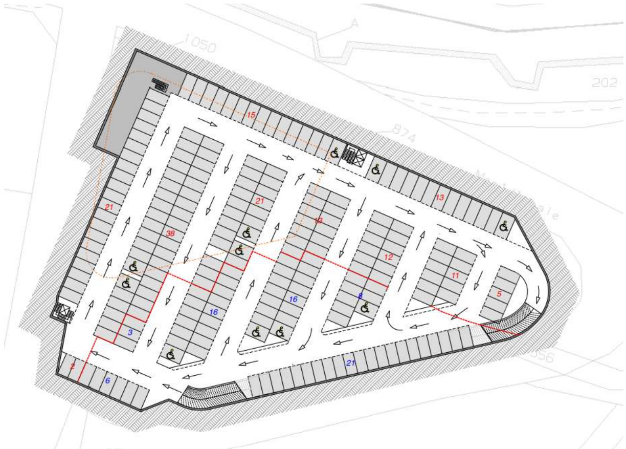
Fig. 2b Estratto progetto architettonico: planimetria interrato (in tratteggio arancione è evidenziata la sagoma dello spiccatto corrispondente all'edificio commerciale)
