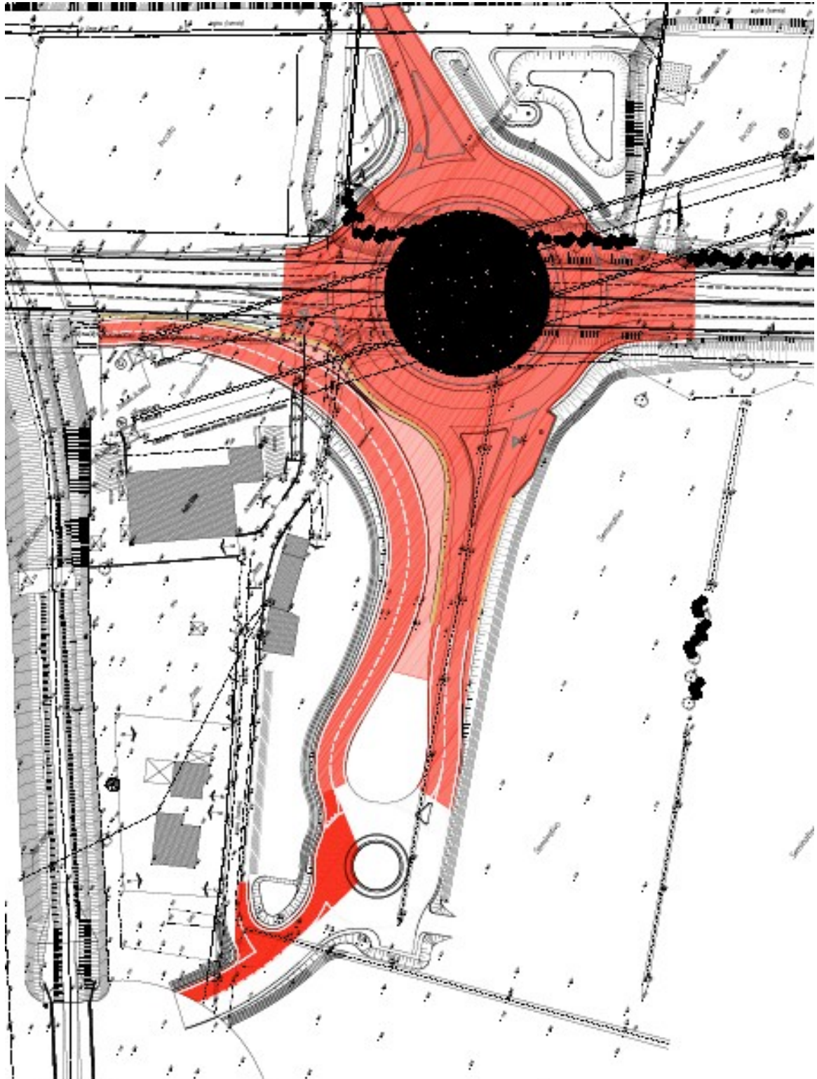
Area lato Ancona rispetto al Mavone: Aree tributarie per tubazioni e vasca di laminazione.
