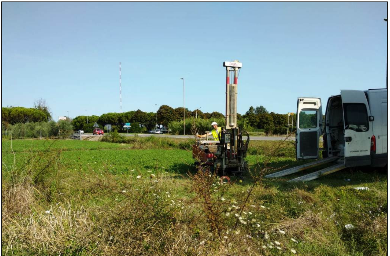
Figura 12 Penetrometro Pagani TG63/200 nel corso della prova
