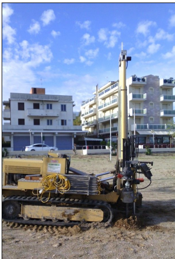
Figura 9 Penetrometro Pagani TG73/200 nel corso delle prove
