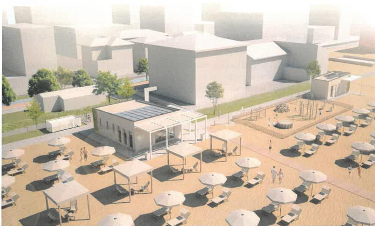
Entrambi i fabbricati sono progettati in struttura prefabbricata in ferro e legno e finitura esterna ad intonaco chiaro ( colorazione bianco/beige ). Le porte esterne sono invece con finitura in legno naturale chiaro. Sulle coperture sono collocati tutti gli impianti (fotovoltaico, pannelli solari, wi-fi, illuminazione notturna, etc). Le fondazioni invece saranno prefabbricate in ferro senza utilizzo di cemento armato.
