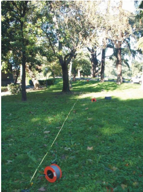
Figura 1: Esempio di misura realizzata con la tecnica dell’antenna sismica. Nel pannello di sinistra, si può osservare la disposizione dei sensori; nel pannello di destra è visualizzata la curva di dispersione.
