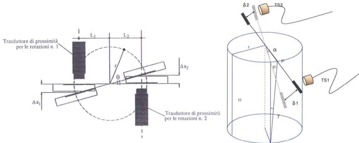
Fig. 2 – Schema di taglio torsionale ciclico
