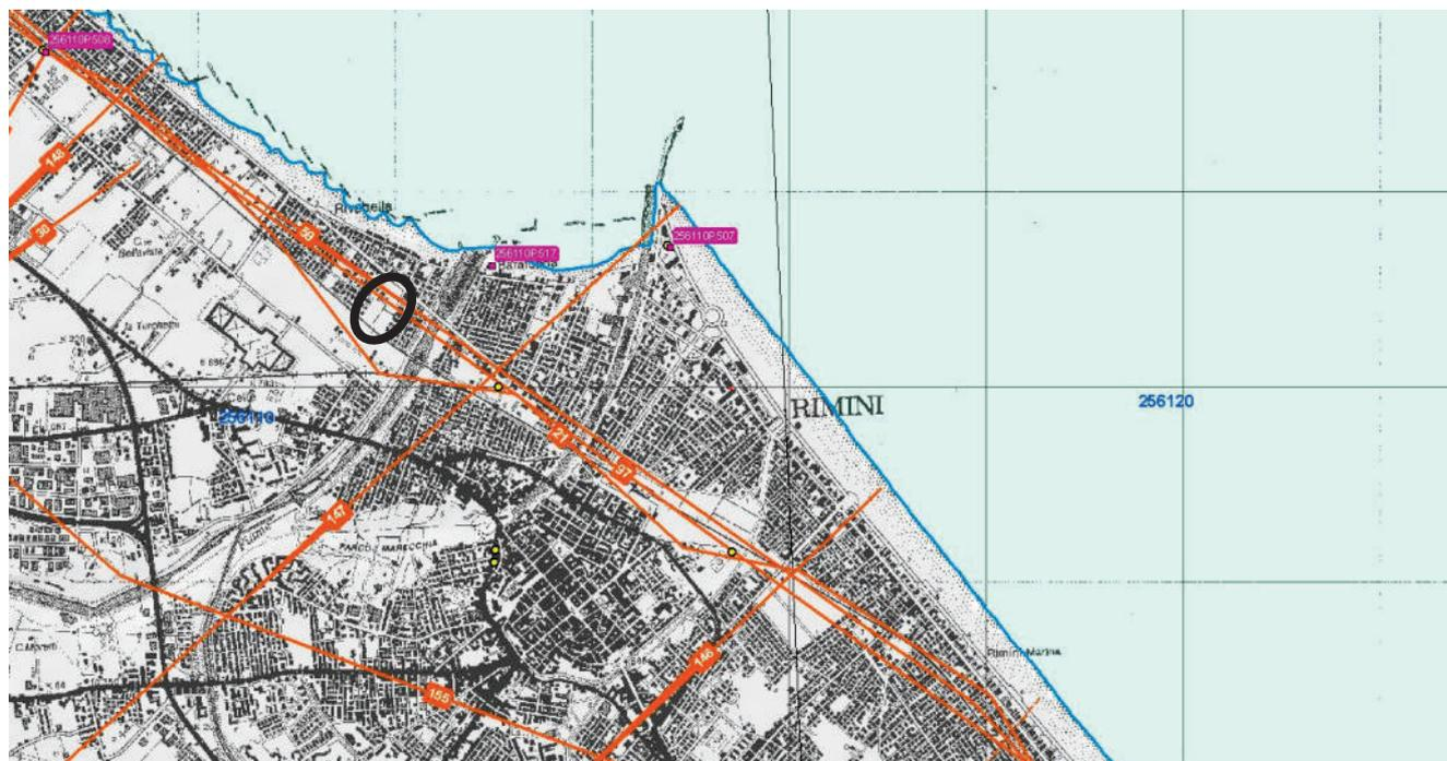
La "Sezione Costiera" n. 59 corre sull'area oggetto di Piano Particolareggiato ed arriva ad indagare uno spessore di oltre 300 mt tramite correlazioni con stratigrafie di pozzi profondi e sondaggi.
