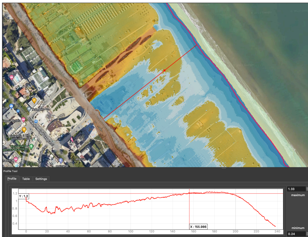
Figura 12 transetto topografico derivato da Lidar - Bagno 29 Rimini Sud – Allagamento con evento di TR = 1 anno
