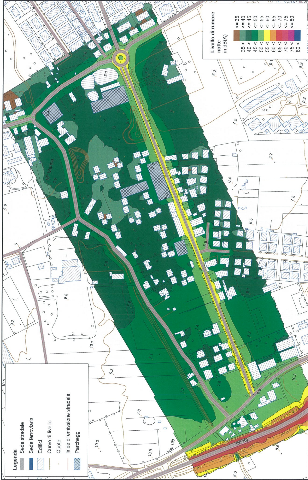
Simulazione dello scenario futuro con flussi di traffico medi orari Tempo di riferimento notturno (quota mappatura 4 m p.c.)
