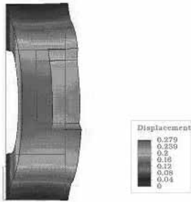
fig. 3 - Deformate modali. Primo modo. freq = 36Hz; vista dall'alto.
