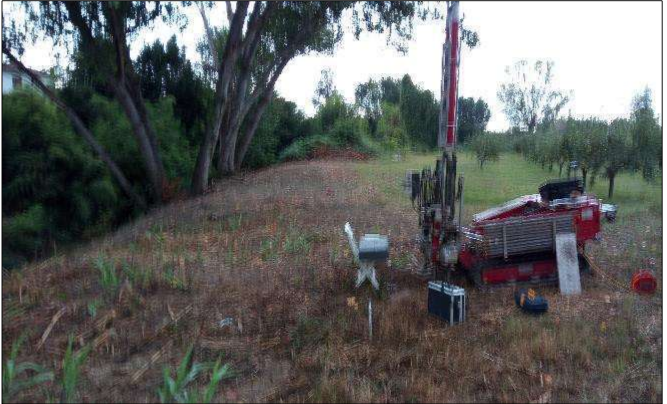
Figura 9 Penetrometro Pagani TG73/200 nel corso delle prove
