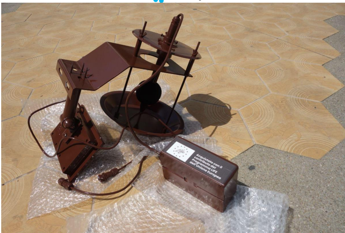
Figura 8: Sensore di rumore in colorazione marrone per i lampioni con verniciatura effetto corten.
